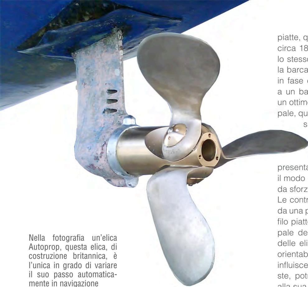
Nella fotografia un'elica Autoprop, questa elica, di costruzione britannica, è l'unica in grado di variare il suo passo automaticamente in navigazione
