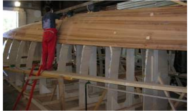
PRIMA FINITURA CON LEVIGATRICE A NASTRO
