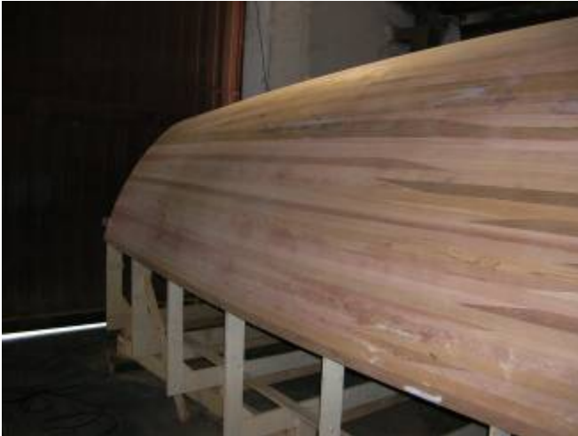
FASCIAME ESTERNO FINITO
