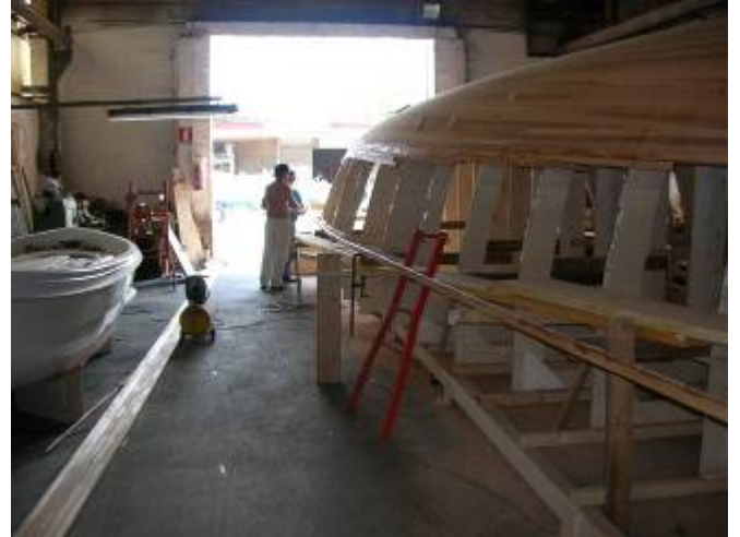
DETTAGLIO MESSA IN OPERA LISTELLI LISTELLO CON COLLA PRONTO
