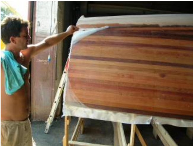
RIVESTIMENTO CON STUOIA 200 GR/MQ E RESINA EPOSS
